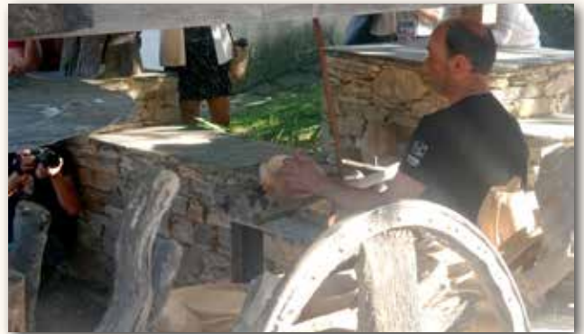
Arturo Iglesias, el “torneiro” del Museo, en la demostración del funcionamiento del torno de media vuelta.
